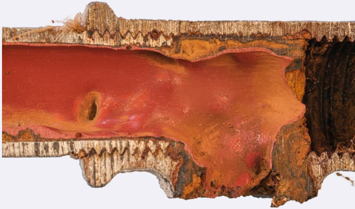
Abbildung 2: Beispielhafte Darstellung eines Formteiles mit einer unzureichenden Innenbeschichtung
